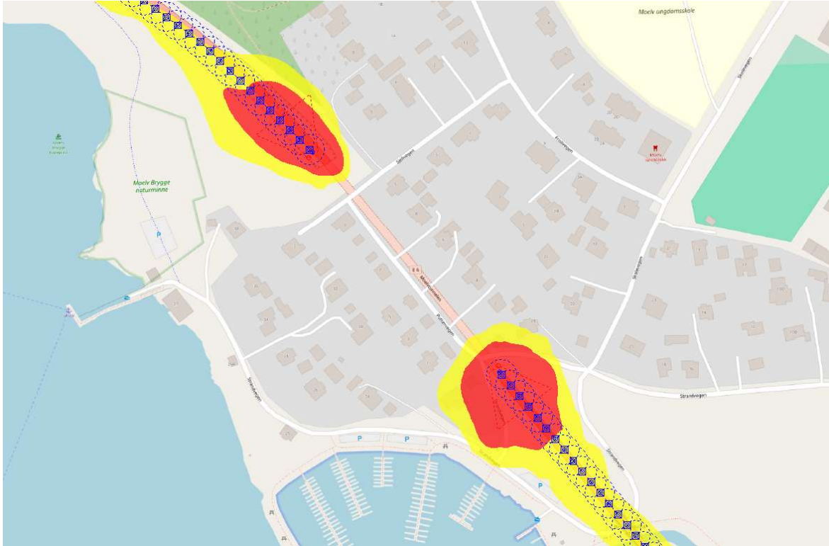
Figur 9-2: Figuren viser spredningskart for PM10 for 0-alternativet, og representerer overskridelsene av grenseverdiene. Kilde: COWI AS
