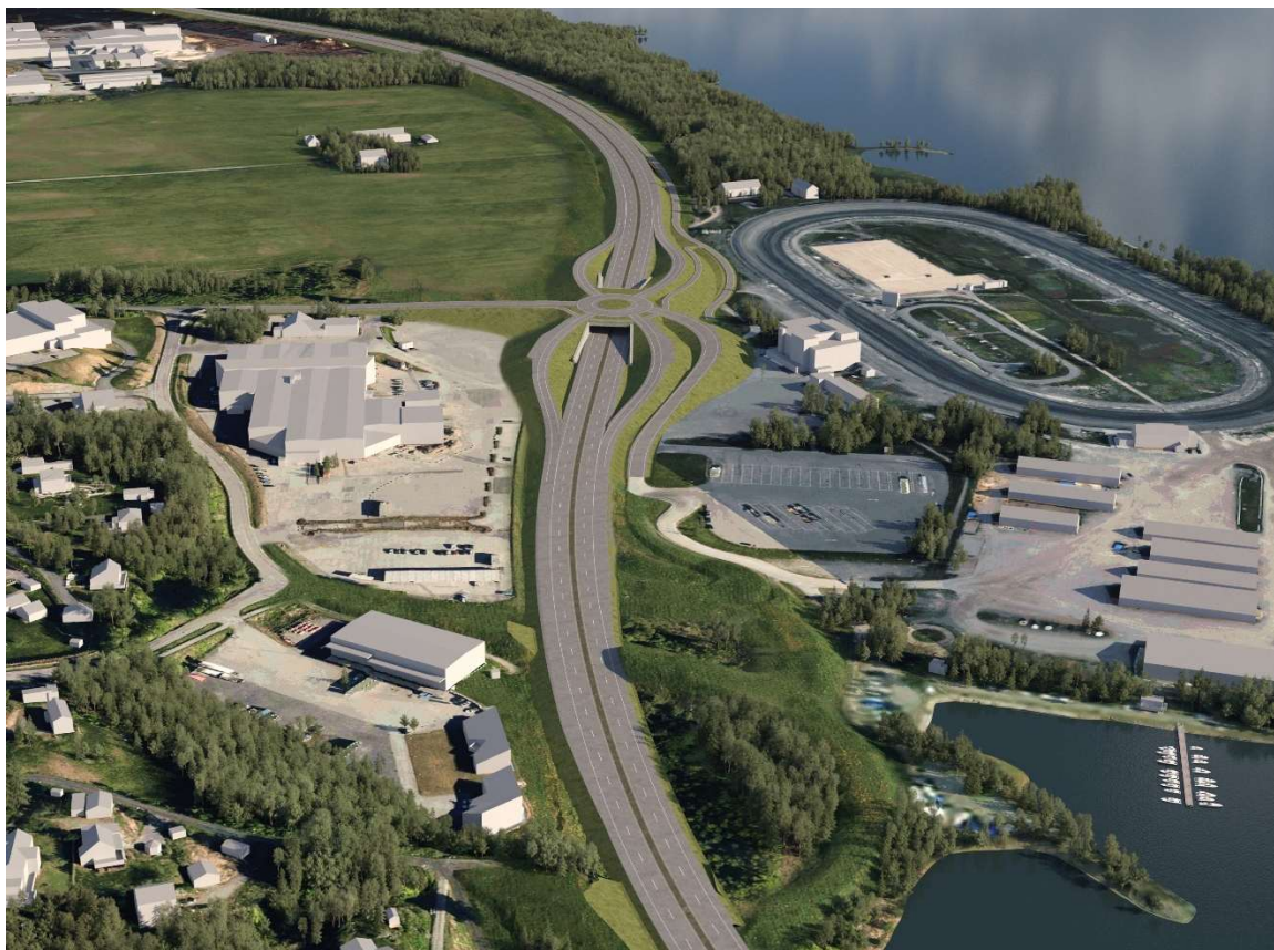
Figur 6-4: Illustrasjonen viser en bearbejdet versjon av KDP-krysset i Biri. På grunn av blant annet arealbeslag anbefales ikke denne løsningen. Kilde: COWI AS
