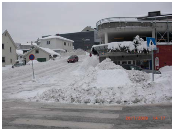
Figur: Eksempel på dårlig plassering av snøopplag
