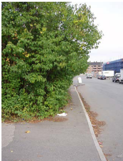
Figur: Manglende nedklipping av privat vegetasjon medfører sikt- og fremkommelighetsproblemer
