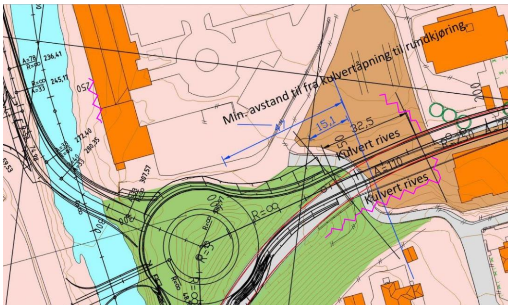
Fig. 3.3.2 Utsnitt fra tegning C001. Rundkjøring på rv.4. Illustrasjon av endret kulvertavslutning. Behov for spunt er markert med rosa linje.
