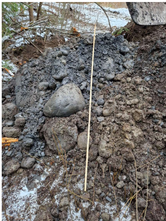
Figur 12: Bilde viser gravemasser fra nedre del av prøvegropp ved borpunkt 23
