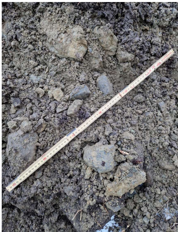
Figur 7: Bilde viser antatt morenemateriale fra prøvegropp ved borpunkt 17, fra 1-2 m dybde
