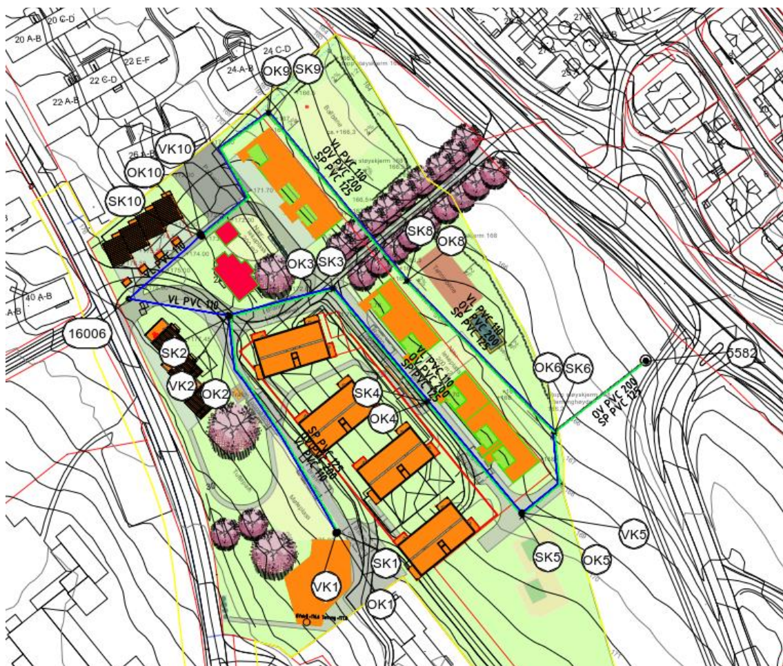
Figur 4. Plantegning med skisserte VA-løsninger
