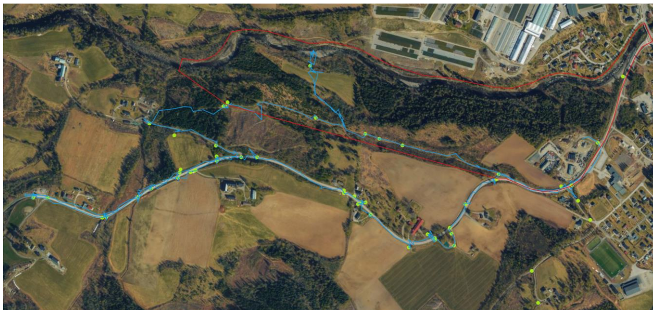
Figur 1: Befaringen fulgte den blå ruta, og det ble markert interessepunkter ved grønne prikker. Dette er typisk stikkrenner gjennom veger. Cirka avgrensning av planområdet er vist med rød linje. Område på nordsiden av Vismunda hvor det gjort terrengendringer og etablert dyrkingsområde er vist med gult stiplet område.
