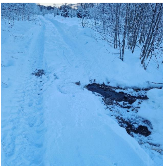
Figur 8: Oppkomme av vann på traktorvegen, like ved borpunkt nr. 14.
