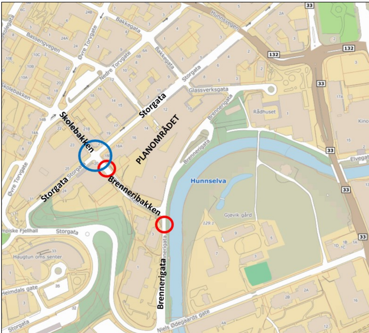
Figur 3 Oversikt over tellepunkter. Manuelle tellinger er gjort i krysset merket med blått, mens automatiske tellinger er gjort i punktene merket med rødt (Kart: finn.no).
