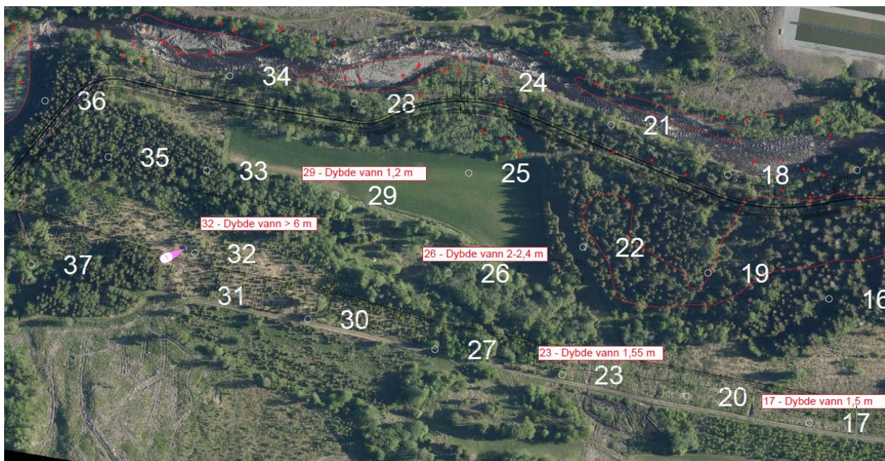
Figur 5: Visuell/manuell innmåling av grunnvannstand i prøvegroper 1. desember 2022..
