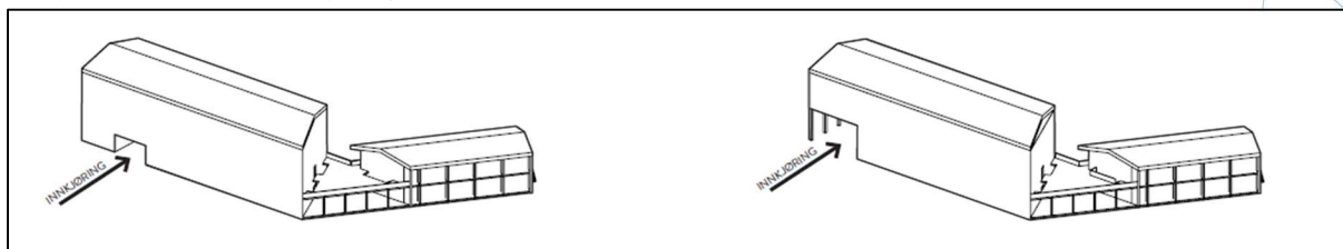
Figur 45, Prinsipppløsning for innkjøring ved dimensjonering for personbil og liten lastebil
