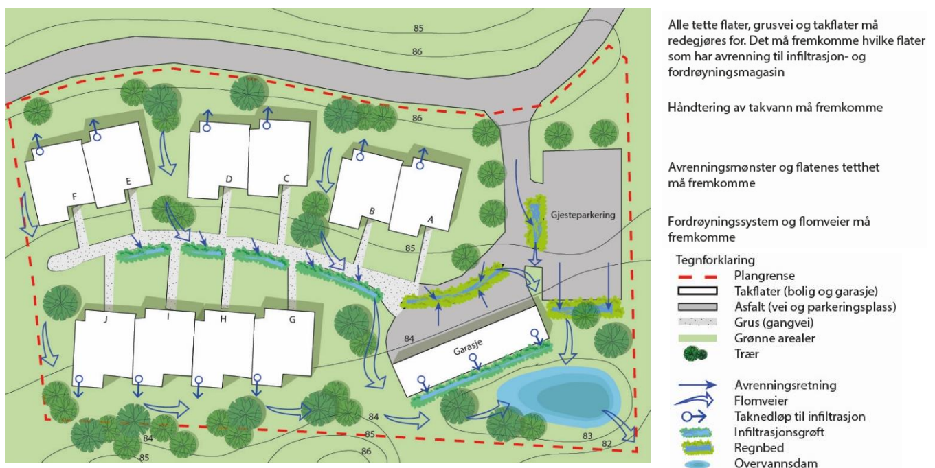
Figur 3. Illustrasjon av overvannshåndtering til en detaljreguleringsplan for boligområde.
