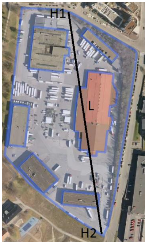
Figur 13. Viser høydene H1 og H2 ( H=H1-H2 ), fra ytterste punkt i feltet til utløpet, samt feltlengden L som er lengden mellom disse høydene.
