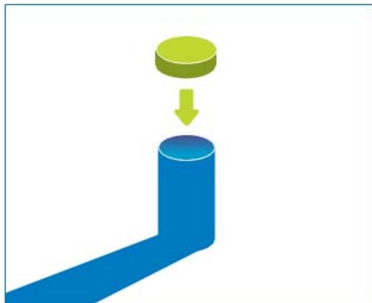
Tett igjen avløpsrøret med et lokk. Tett med en pakning eller silikon for å forhindre lukt.
