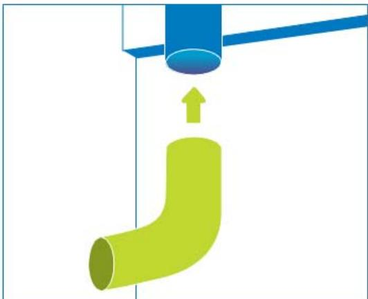
Sett nedløpsrøret på plass igjen og monter utkastet. For å unngå skader må vannet ledes bort fra grunnmur ved hjelp av et kort rør e.l.
