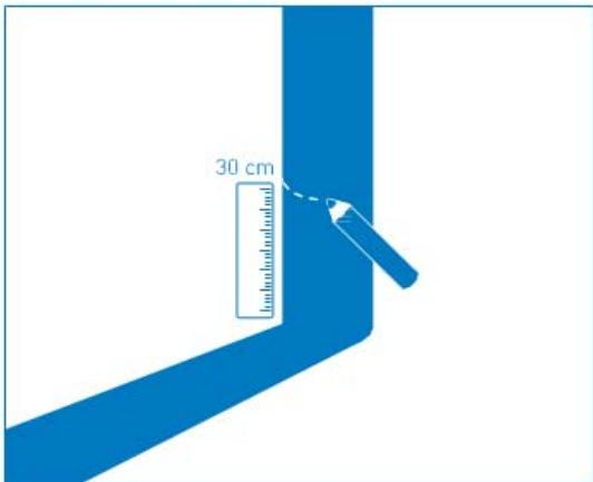
Sett et merke på nedløpsrøret 30 cm over bakken, løsne deretter røret og ta det ned.
