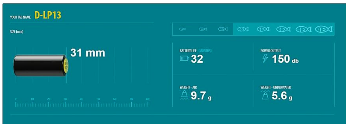
Figur 86. Merker av typen D-LP13 fra Thelma Biotel ble implantert i bukhulen til 16 laker i denne studien.
