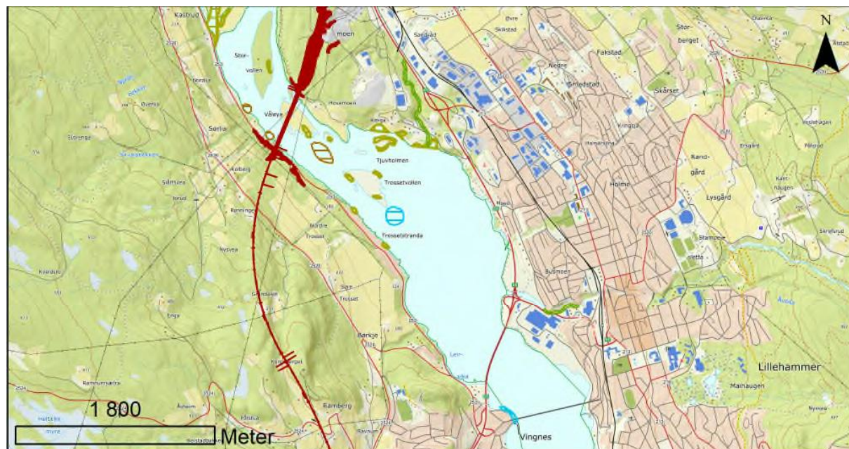
Figur 54. Lågendeltaet og inntegnet trasé for ny E6.
