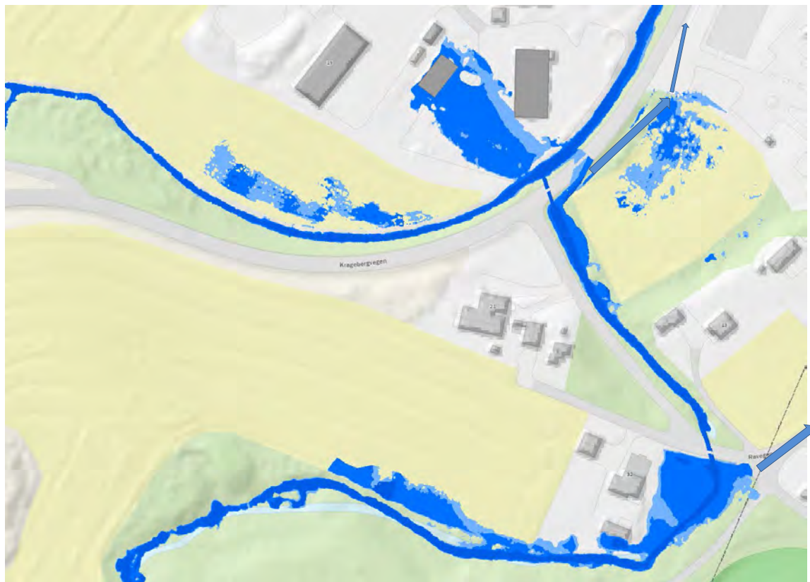
Figur 38 Overtopping av side på bekkeløp i Brynstadbergbekken.
