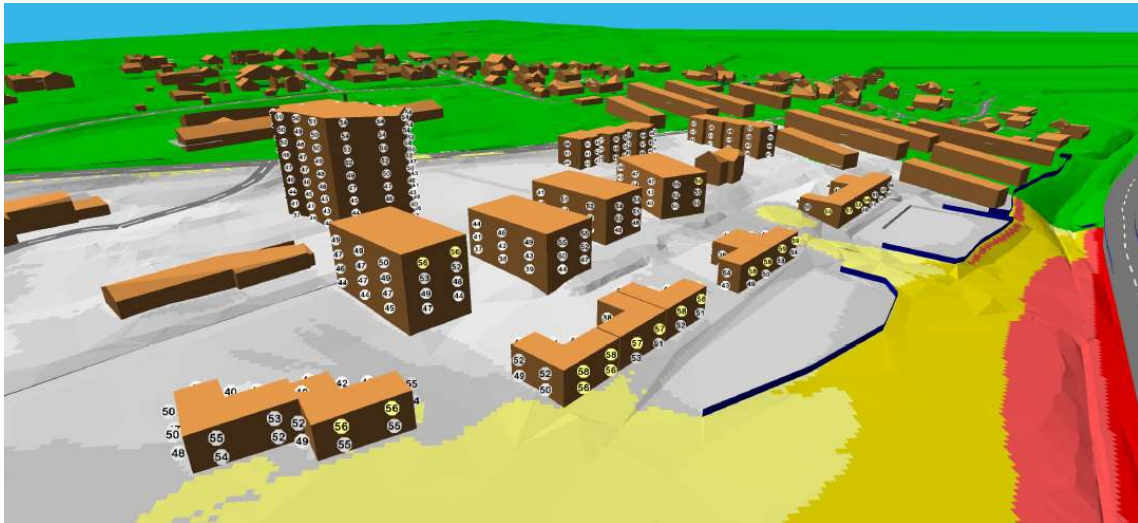
Figur 62: Perspektivet viser utslag av støy inn i området, og på fasader (SWECO Norge, 2020).
