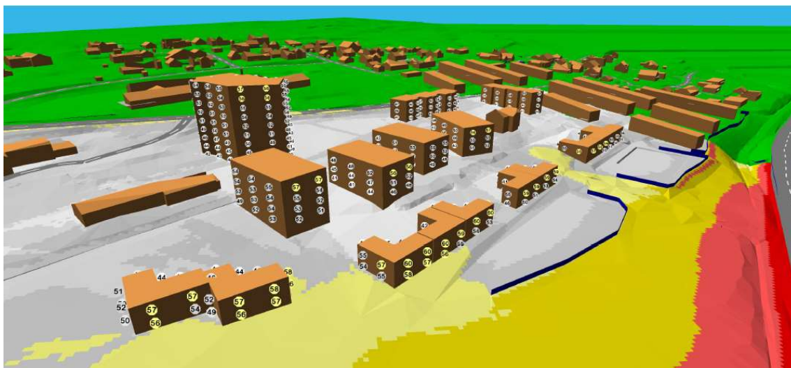
Figur 64: Perspektivet viser fremtidig støysituasjon med fremtidig biltrafikk og fremtidig vegsystem, med tiltak (SWECO 2020).
