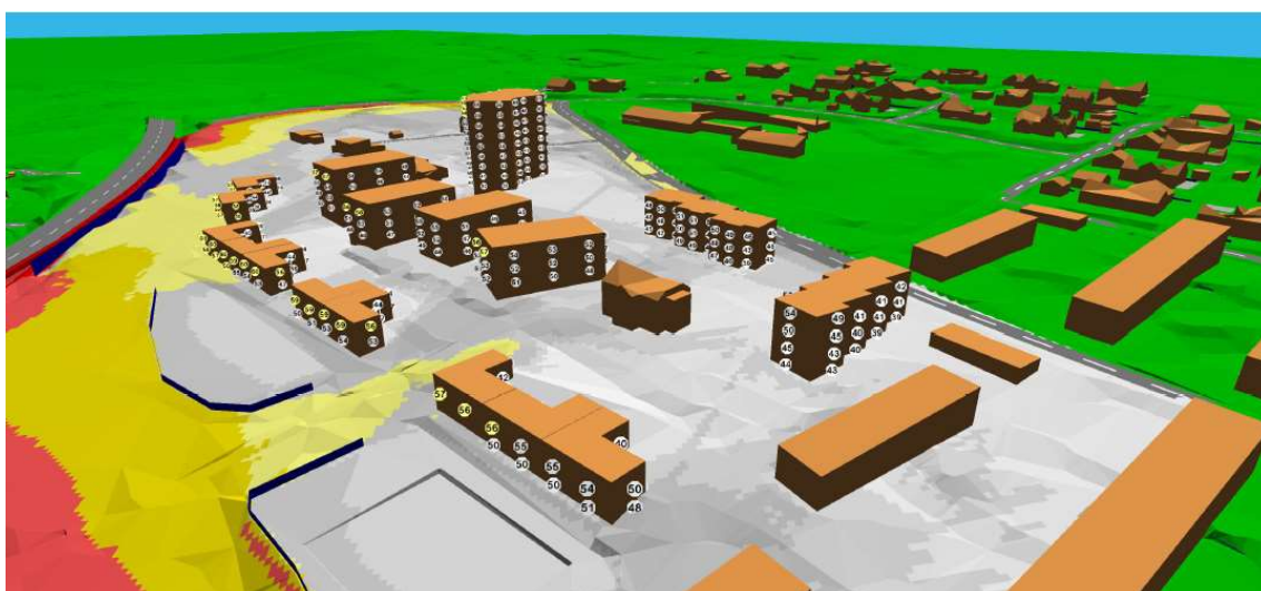
Figur 65: Perspektivet viser fremtidig støysituasjon med fremtidig biltrafikk og fremtidig vegsystem, med tiltak (SWECO 2020).
