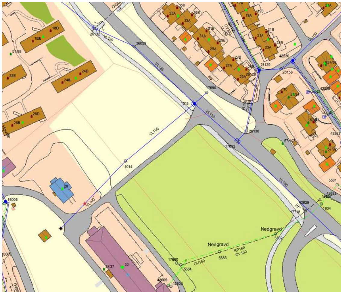
Figur 21: Kartutsnittet viser eksisterende kommunalt overvannsnett i området. I nedre del av utsnittet ser vi en overvannsledning fra området på 150mm diameter (OV150). I øvre del av utsnittet ser vi en overvannsledning under kulverten på 200mm diameter (OV200).
