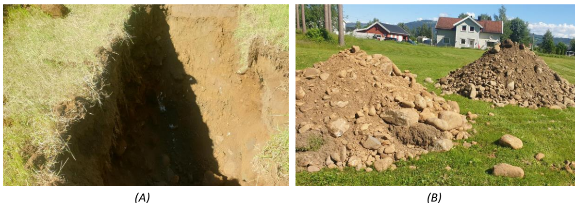
Figur 1: bilder fra grunnundersøkelsene d. 23.06. (A) Jordlag ved utgravning, (B) oppgravede jordmasser, her ses det at jorden ved tiltaksområdet består av breelavsetning med forskjellig kornstørrelse fra fin sand og silt til grus, stein og blokk
