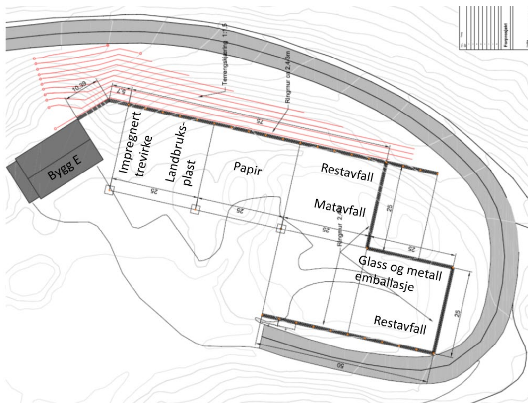
Figur 1 Oversikt over plassering av fraksjoner i omlastningsbygg
