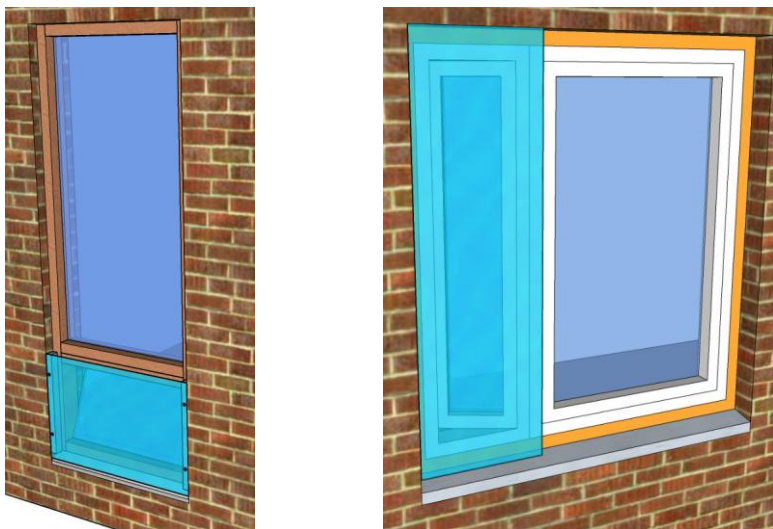
Figur 6. Eksempel på lokal skjerm foran vindu. Lokal skjerm foran vinduet vises med turkis farge.
