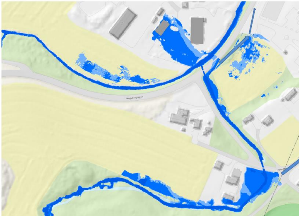
Figur 7: Overtopping av side på bekkeløp i Brynsstadbergbekken (Sweco, 2021).
