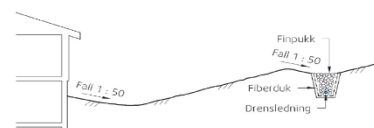
Figur 36-Eksempel på avskjærende grøft
