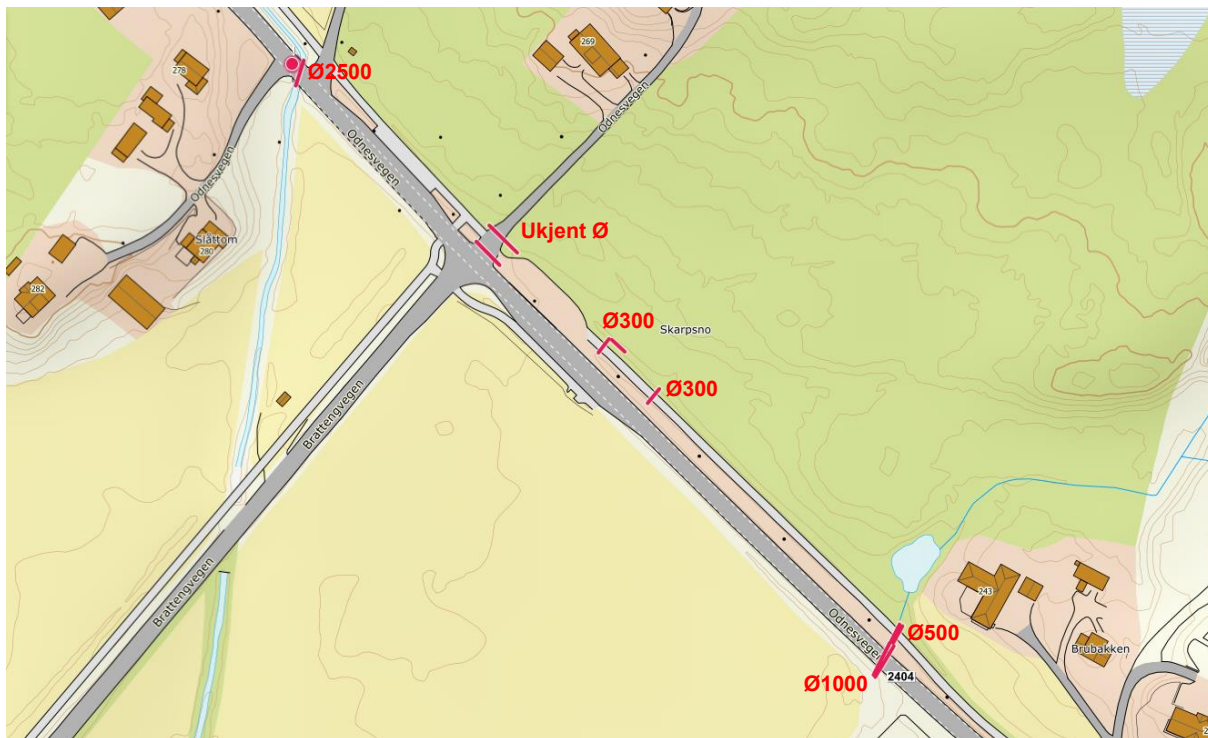
Figur 6: Registrerte stikkrenner (kilde: Statens Vegvesen, oktober 2024).
