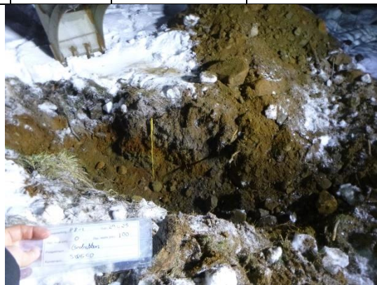
Bilde 33: Jordprofil i hullet på 1 meters dyp
