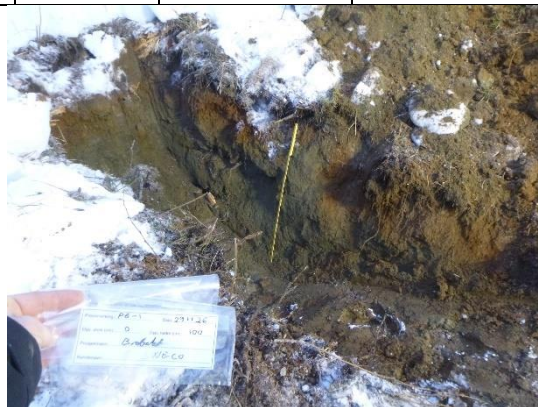
Bilde 25: Jordprofil i hullet på 1 meters dyp
