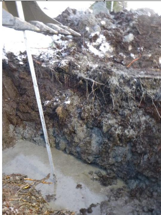
Bilde 6. Jordprofil i hullet på 2 meters dyp
