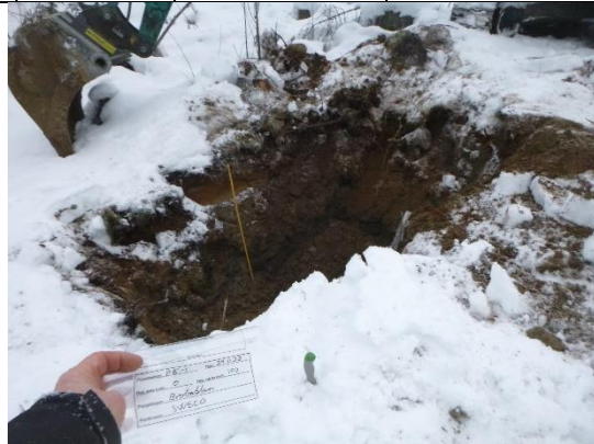
Bilde 20. Jordprofil i hullet på 1 meters dyp
