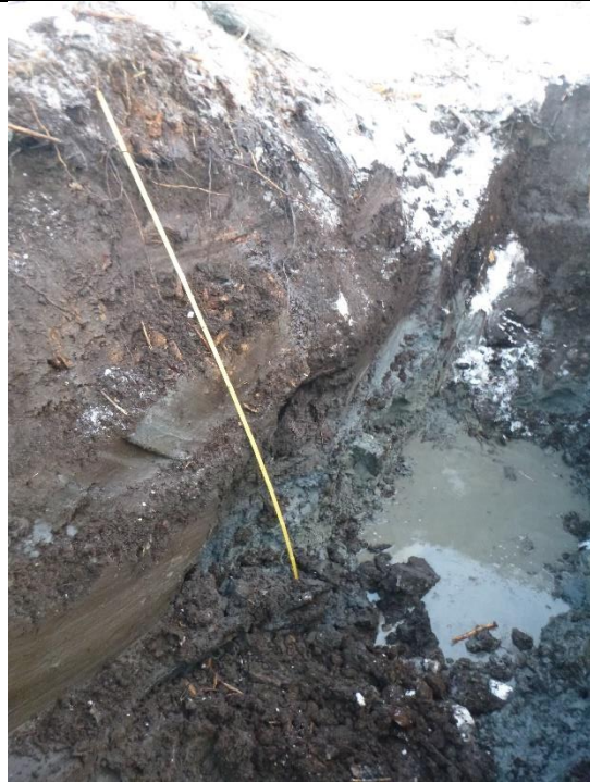
Bilde 12. Jordprofil i hullet på 2 meters dyp.
