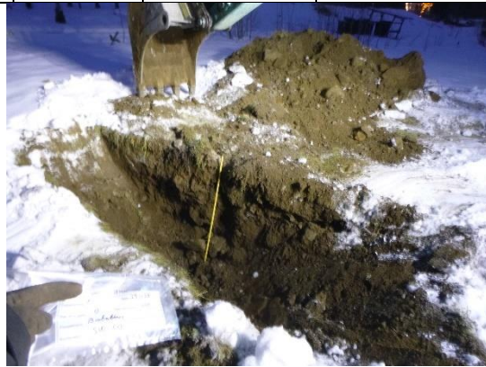
Bilde 2: Jordprofil i hullet på 1 meters dyp
