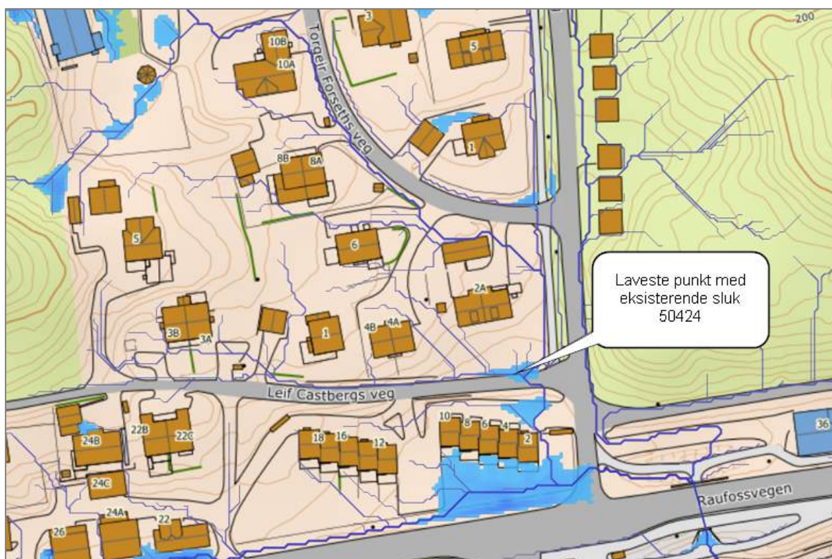
Figur 6. Oversikt over dagens avrenningsmønster (kilde: scalgo.com)
